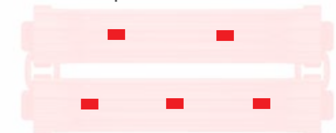
2 Spikes pro Bodenplatte, nächste Platte 3 Spikes in versetzten Reihen*
