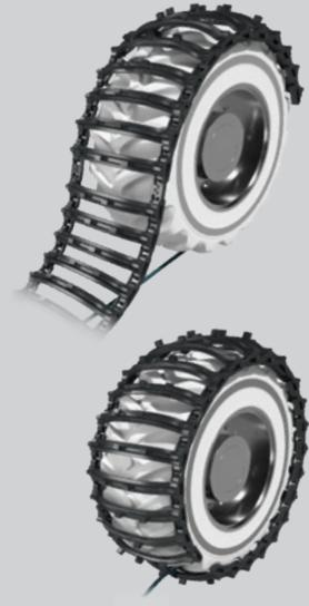
**Bandspannung:** Die Entfernung einer vollständigen Bodenplatte kann erforderlich sein, um die richtige Spannung zu erhalten. Dies hängt davon ab, ob das Band an einem neuen oder abgenutzten Reifen montiert ist.
